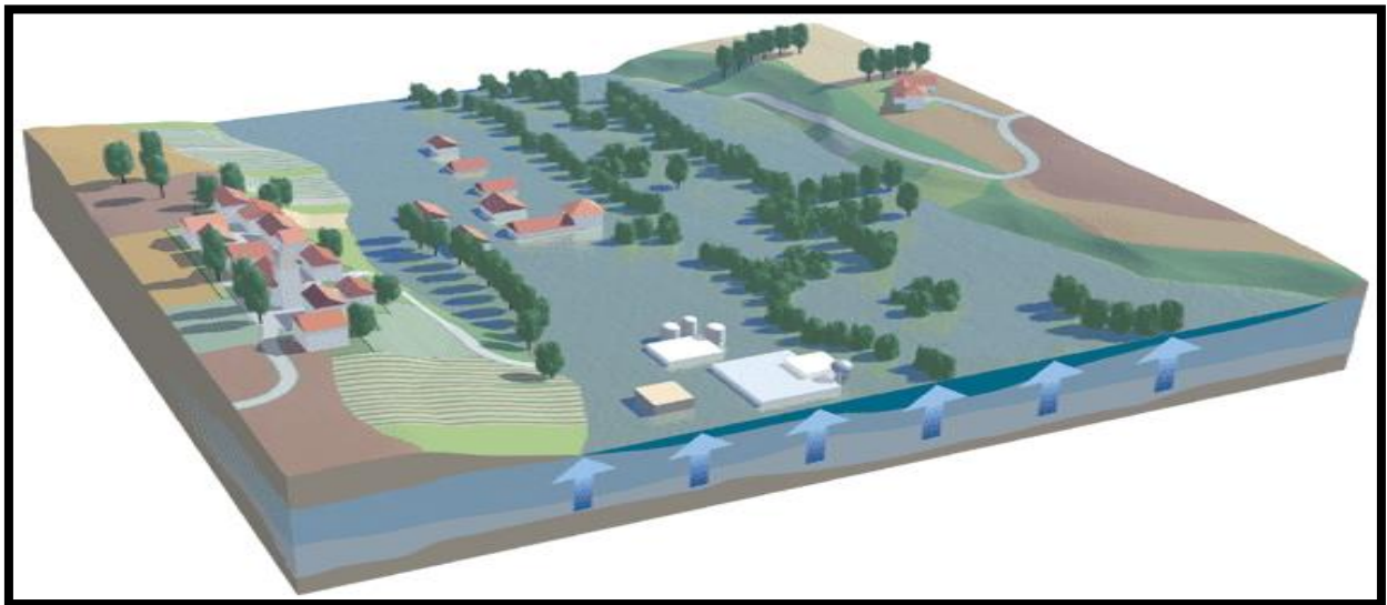
Figure I-8 : Inondation par remontée de nappe phréatique
